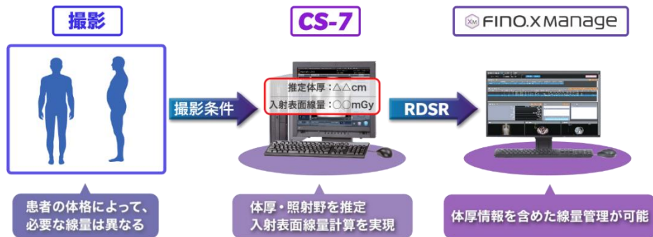
図8 一般撮影コンソール CS-7 における入射表面線量算出機能
